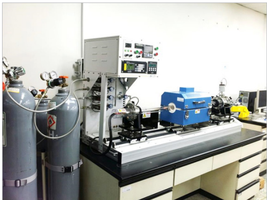
Thermal chemical vapor deposition 열화학기상증착장비(CNT, 그래핀 합성)
