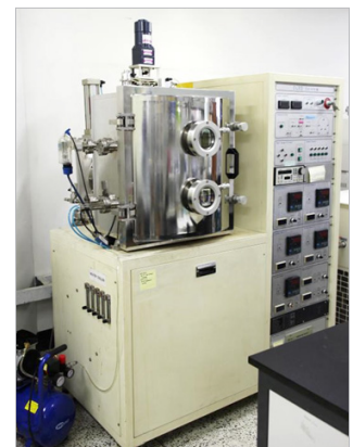
Thermal evaporation system 진공열증착장비
